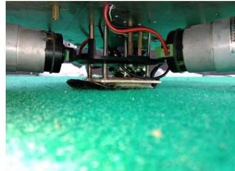
Gambar 8. Realisasi peletakan *sensor optical mouse*
